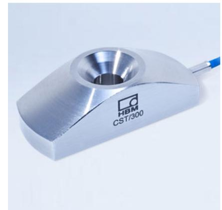
O sensor de deformação piezoelétrico compacto CST/300 é uma opção ideal para medição indireta de força, por exemplo no
