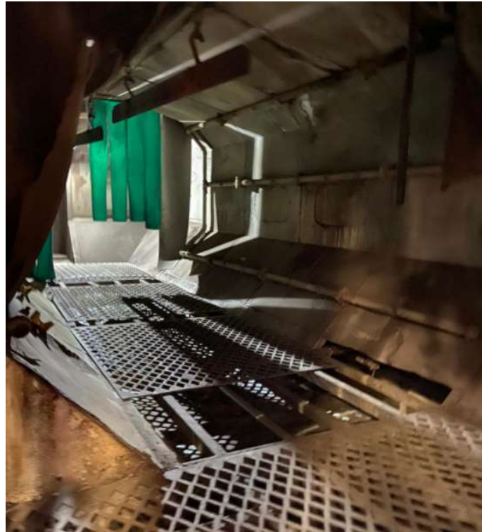
Figura 3 – Lavadora de Peças, vista interna da lavadora.
